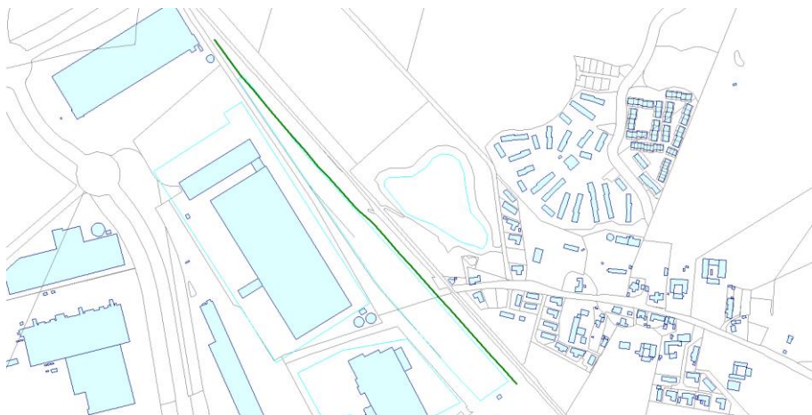
Figur 8: Udstrækning af støjskærm langs østsiden af området
